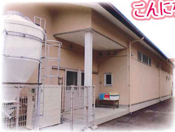
給食室はペレットボイラーになりました。写真の左に写っているのがペレットを入れるものです。
